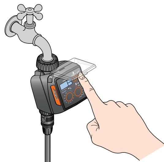
**IT RAIN SENSOR.** Il programmatore è predisposto per il collegamento ad un sensore di pioggia (Rain Sensor), via cavo (cod. 90915) oppure via radiofrequenza (cod. 90831). Quando l'acqua piovana all'interno del Rain Sensor supera i 5mm di pluviometria, il sensore sospende automaticamente l'irrigazione, per poi riprenderla quando l'acqua è evaporata.
